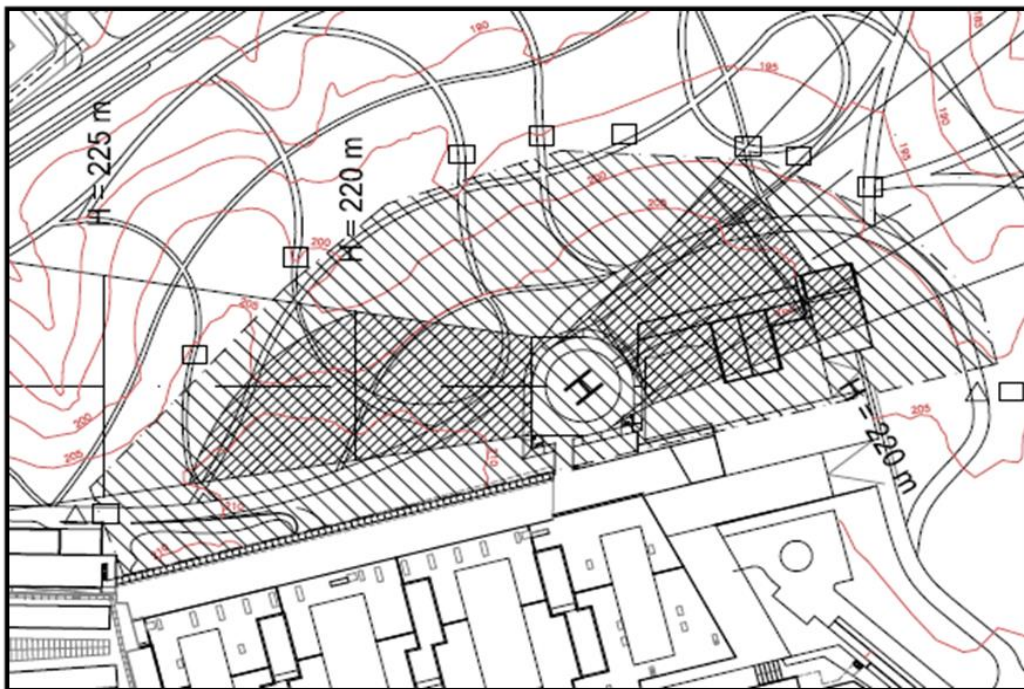
Zona de aproximación y despegue afectada por la corriente descendente del rotor
